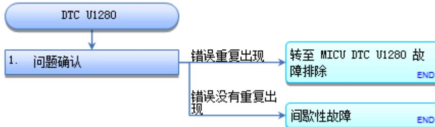
**DTC U1280:** 备用控制单元通信总线线路故障 (总线关闭)
